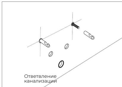
1. Накрутите шпильки инсталляции направляющие креплений таким образом, чтобы проточки и стопорные винты соответствовали друг другу.
