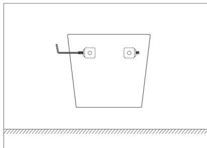
5. Затяните винты и зафиксируйте биде.
